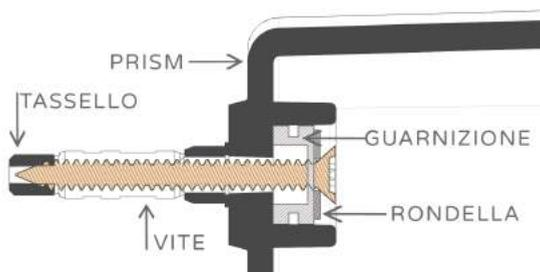
**⚠ Il grado di protezione IP di Prism è garantito solo se sono utilizzate le viti e rondelle in dotazione (o equivalenti)**
