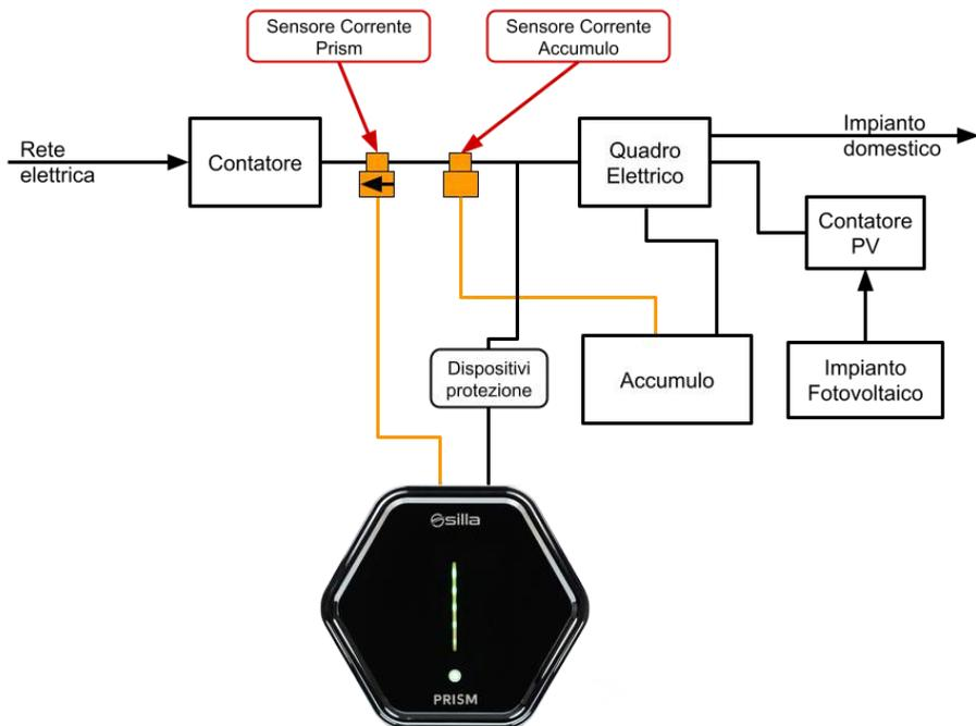
In questa configurazione Prism avrà priorità sul consumo di energia solare rispetto al sistema di accumulo, che inizierà a caricarsi solo quando l'auto interrompe la ricarica perchè la batteria è carica, o per limiti impostati dall'utente. Quando l'energia dall'impianto fotovoltaico non è sufficiente, **Prism preleverà energia solo dalla batteria di accumulo** in modalità Solar, o dall'accumulo e dalla rete in modalità Normal, fino al limite di corrente impostato dall'utente.
