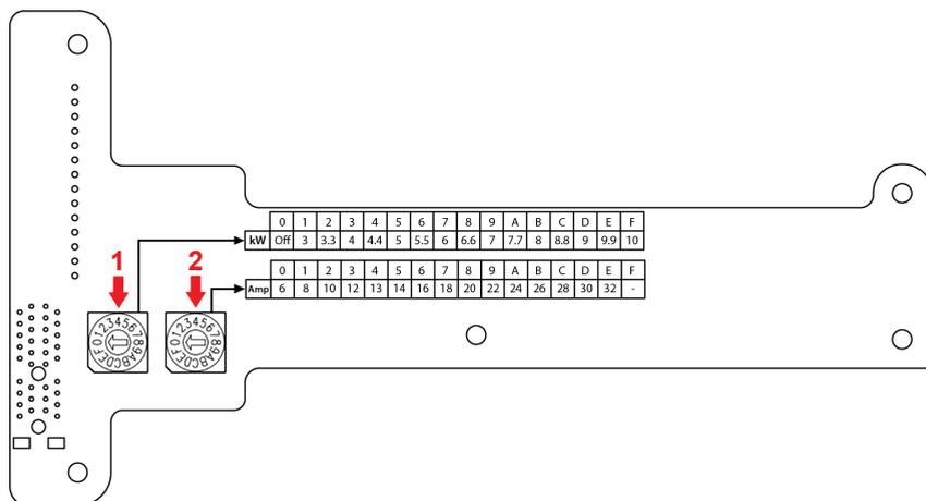
1. **kW**: tramite questo switch viene regolata la **potenza massima** prelevabile dalla rete. Prism abbasserà quindi la corrente di carica, quando necessario, per non superare questa potenza.
