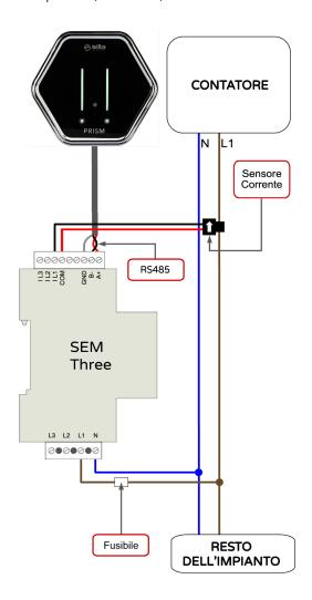
Utilizzare fusibili di tipo **gL (IEC 269) o tipo M da 0.5A a 2A** per la protezione dello strumento.
