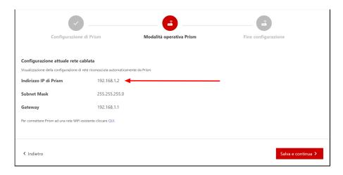
**nota.** consigliamo di assegnare a Prism un IP fisso (dal router o dalle impostazioni di Prism) in modo da raggiungere l'interfaccia più comodamente tramite rete locale, utilizzando il nuovo indirizzo IP invece che quello di default 192.168.8.1.
