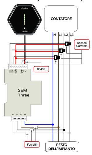
Per l'installazione del dispositivo (SEM Three) riferirsi al relativo manuale in dotazione. Utilizzare fusibili di tipo **gL (IEC 269) o tipo M da 0.5A a 2A** per la protezione dello strumento.
