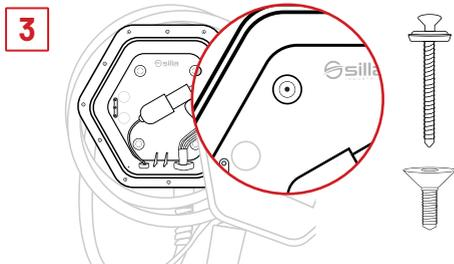
Identificare i 4 fori presenti sulla base e fissare Prism Dummy alla parete o al palo con i tasselli o le viti in dotazione.
