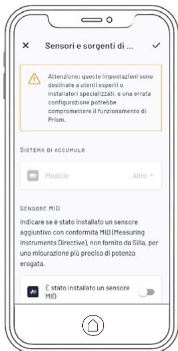
► Nella schermata “**Sensori e sorgenti**” si può indicare se ci sono sorgenti alternative al sensore di Prism per la gestione del bilanciamento dinamico dei carichi e se, ai fini di rivendita dell’energia elettrica, è stato collegato un  **sensore MID** compatibile.
