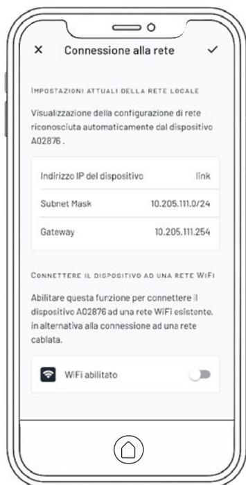
► Nella schermata **“Connessione alla rete”**, è possibile verificare l’indirizzo IP assegnato al dispositivo dal router e gestire la connessione WiFi alla rete domestica.
