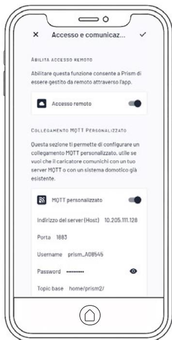
► Nella schermata “**Accesso e comunicazione**” è possibile attivare la **comunicazione con il cloud** per la gestione di Prism da remoto e configurare il collegamento ad un server **MQTT** privato per la domotica.
