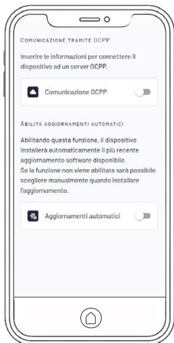
► Nella schermata “**Accesso e comunicazione**” è possibile inoltre collegare Prism ad un **broker OCPP** per la rivendita dell’energia. Inoltre è possibile determinare se Prism si **aggiorni** o meno in automatico.
